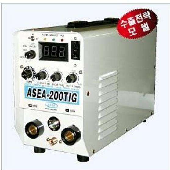
Сварочные инверторные аппараты для аргоно-дуговой сварки ASEA-200TIG и ASEA-300TIG предназначены для дуговой сварки неплавящимся вольфрамовым электродом в среде аргона (режим TIG) на постоянном токе изделий из легированных и нержавеющей сталей и сплавов титана, меди, бронзы, латуни и других металлов, кроме алюминия, а также для ручной сварки штучным покрытым электродом (режим MMA).
