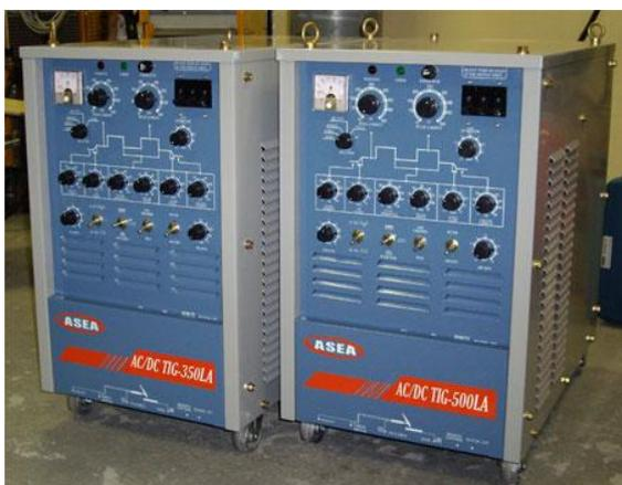
Инверторные сварочные аппараты для аргодуговой сварки серии LA предназначены для сварки на постоянном и переменном токе изделий, имеющих большие толщины, из стали, титана, магния, меди, бронзы, латуни, алюминия и его сплавов неплавящимся электродом (TIG AC/DC) с контактным и бесконтактным поджогом дуги (HF). Оборудование может комплектоваться блоком водяного охлаждения.
