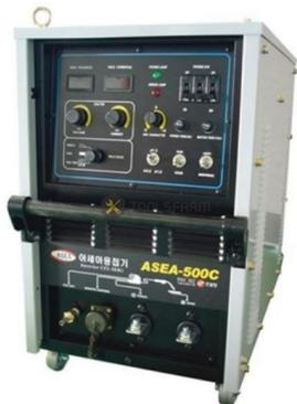
Это мощный сварочный аппарат для сварки MIG/MAG, идеально подходящий для сложных условий эксплуатации. Ключевыми показателями являются превосходная производительность до 500А при рабочем цикле 40 % и легкий способ регулирования зажигания дуги – даже при сварке с использованием защитного газа CO2.
